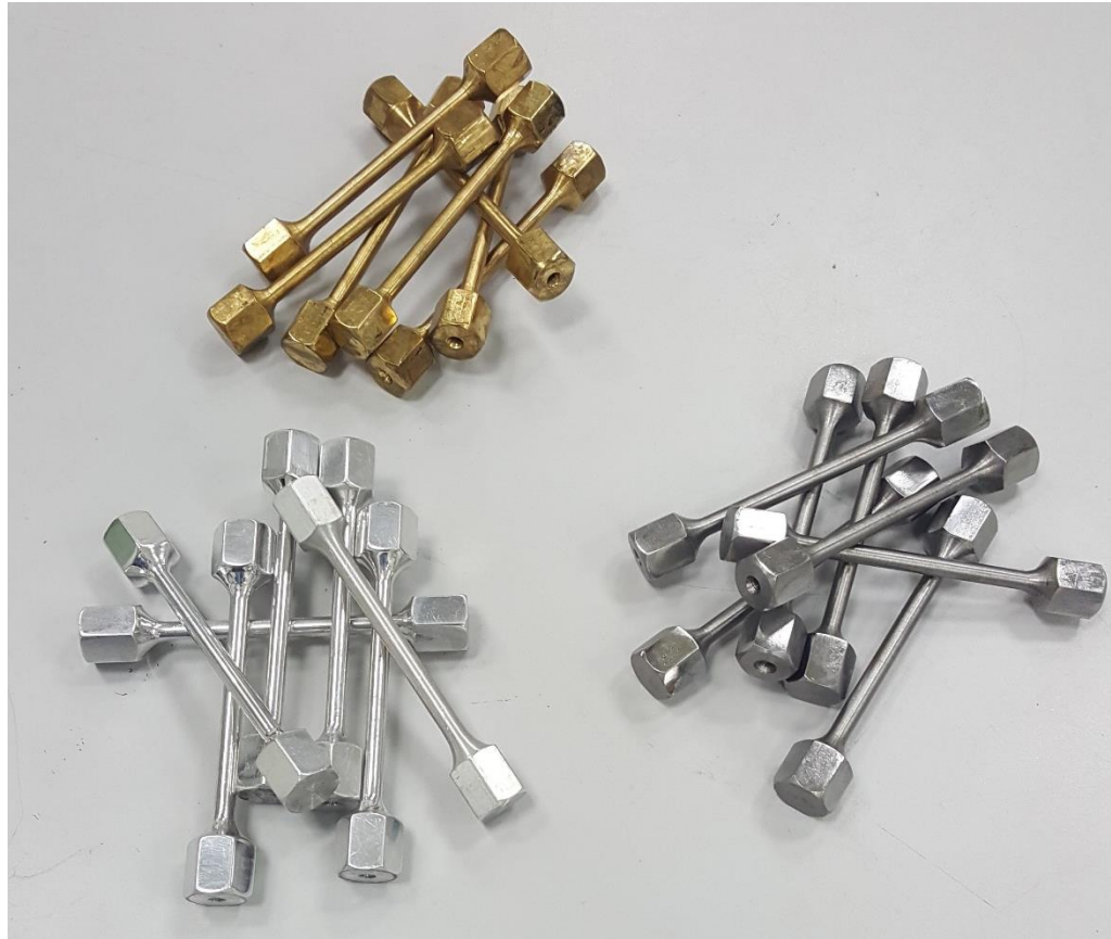
شکل ۱: انواع نمونه های استفاده شده در آزمایش پیچش
